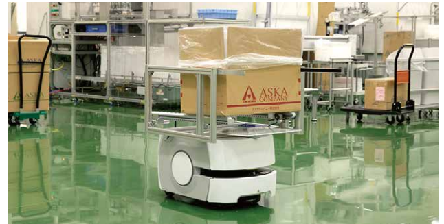
無人搬送車で包装品搬送により工場の夜間無人化生産が可能に
