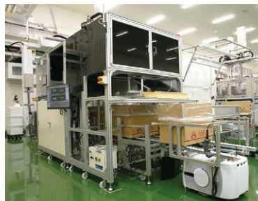
箱が満杯になると自動的に自動搬送車が箱を替える
