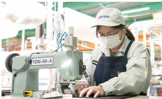
超音波ミシンの導入で作業時間が大幅に短縮された
