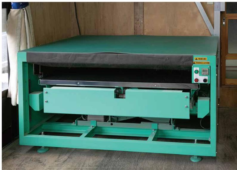
従来の畳製作の手法を覆す小型熱圧着機
