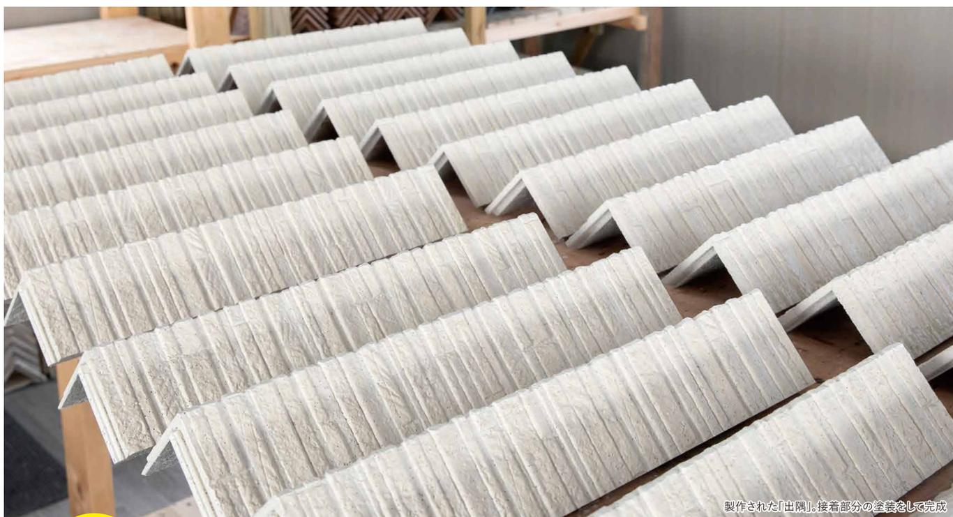
製作された「出隅」。接着部分の塗装をして完成
