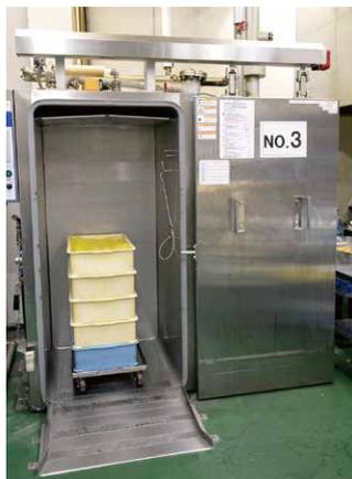
真空冷却機で急速冷凍
