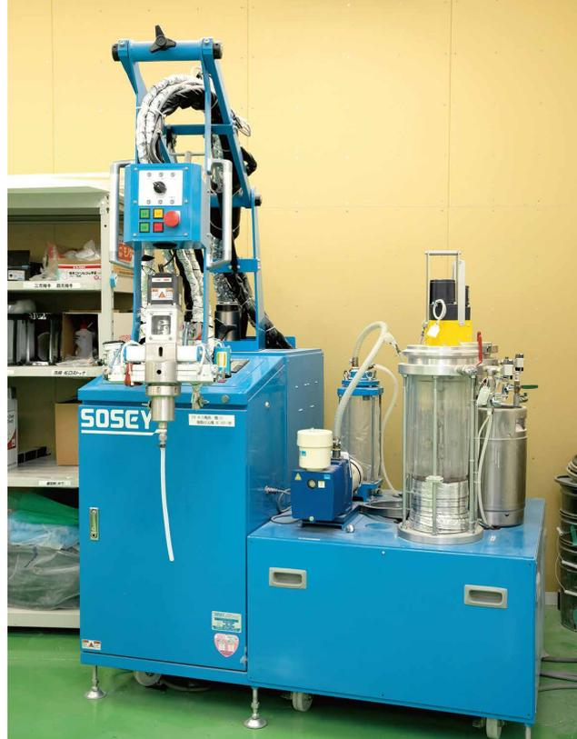
大型成形体製造のための樹脂注入装置
