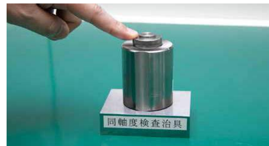
1000分の5ミリ以下を実現した検査治具
