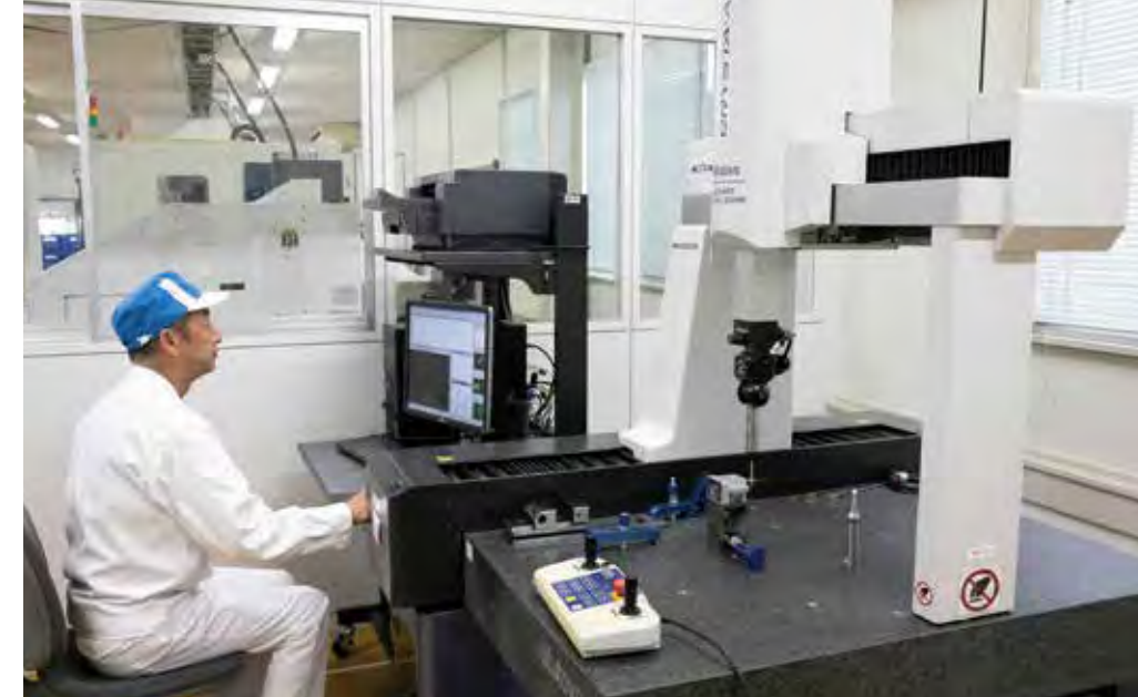
フロアの振動を完全にシャットアウトした測定室も整備
