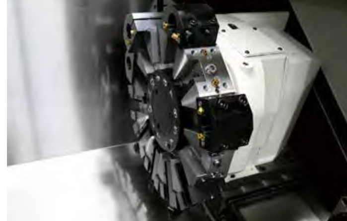
加工途中での製品の着脱が不要になり同時加工が可能になった
