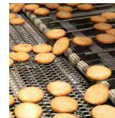
整列させないと不良率が15%程度発生する
