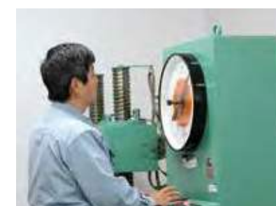
コンクリートの強度を検査する
