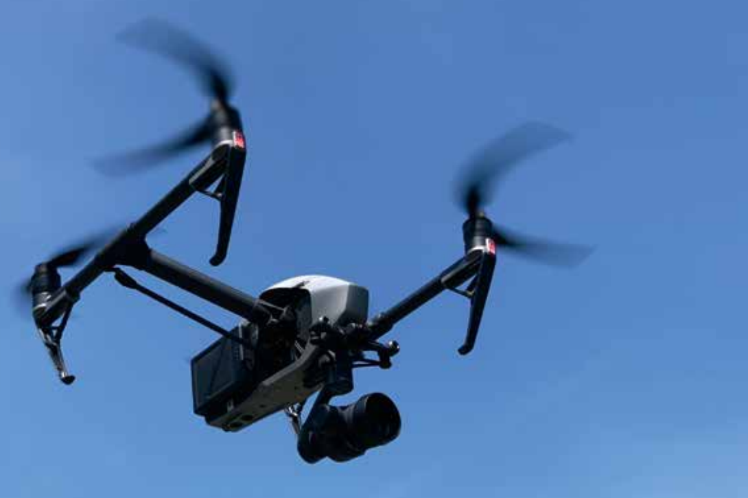
ブレードから15〜20m離れた位置から撮影する。より人の目に近い映像を得るために、操作技術を磨いてきた
