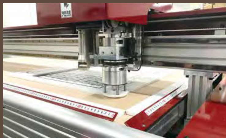
曲線カット、直線V字カットなど製品化に必要なカッティングが可能
