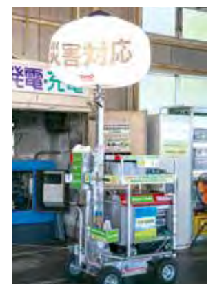
災害時にも蓄電池や自家発電で対応できる
