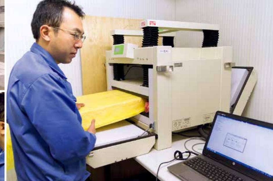
わずか2時間で試験体の熱伝導率を測定
