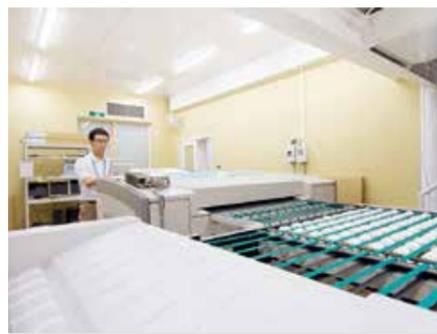
湿度を従来以上に徹底して管理した上でインク量と湿し水の水温及び供給量の調整を行い、速乾印刷を支える印刷版であるサーマルCTPプレートの出力条件の最適化を行った。
