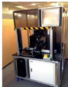
また、欠陥検査を行う検査部を中心として、多様な製造現場に対応できる装置の開発、さらには汎用表面欠陥検査装置全体を制御し画像処理を行うために、組込アプリケーションの開発にも取り組んだ。
