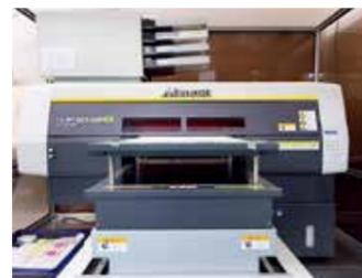
際に加飾を行った。その後、技術開発紹介用の評価用サンプルとなる射出成型品の金型を作製し、射出成形モデルを成型。加飾を行って評価用サンプルを作製した。この一連の流れをもとにプリンター加飾加工の管理手法を構築し、ダイレクト加飾システムを量産加工工程に取り込むこととした。
