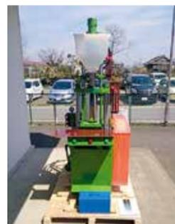
試作製造に当たっては、多品種小ロット商品をワンストップで製作できるエラストマ成形機と、表面実装基板のLEDとセンサーの位置に約0.1mmの精度を実現する高精度チップマウンターを導入した。
